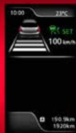
Prikaz nastavljene hitrosti aktivnega tempomata in nastavljene razdalje med vozili (samo pri opremah PREMIUM in ELEGANCE).
